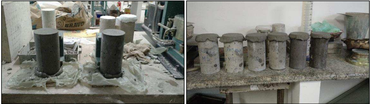
Figura 19 - Capecamento dos corpos de prova.
