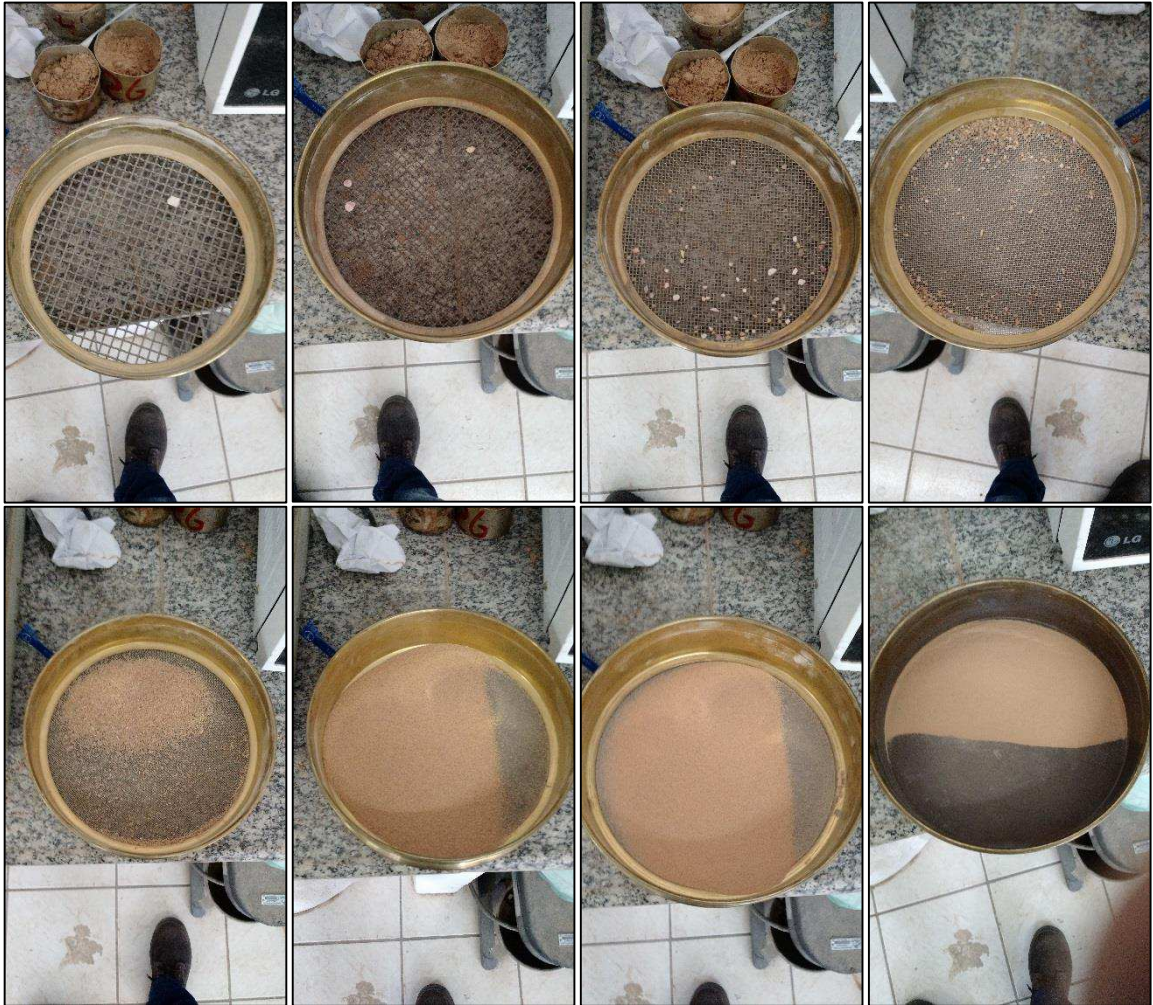
Figura 7 - Sequência do material retido no peneiramento da areia.
