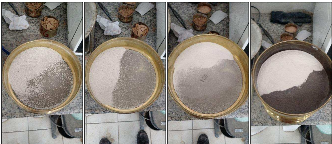
Figura 13 - Sequência do material retido no peneiramento do Vidro.
