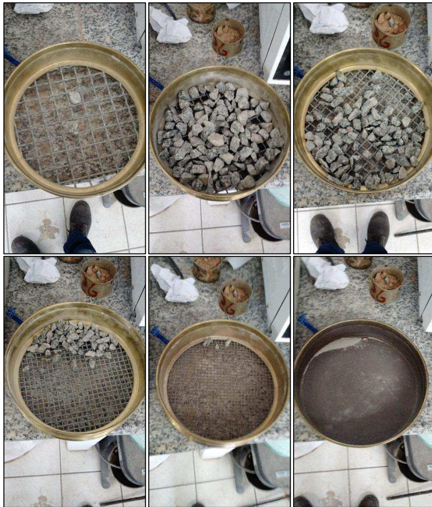
Figura 9 - Sequência do material retido no peneiramento da brita.
