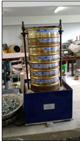
Figura 6 - Peneiramento com agitador mecânico.
