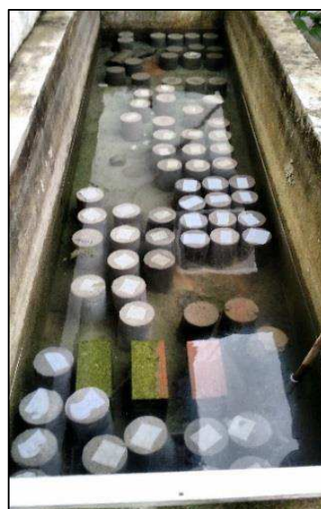
Figura 17 - Corpos de prova submersos para cura.
