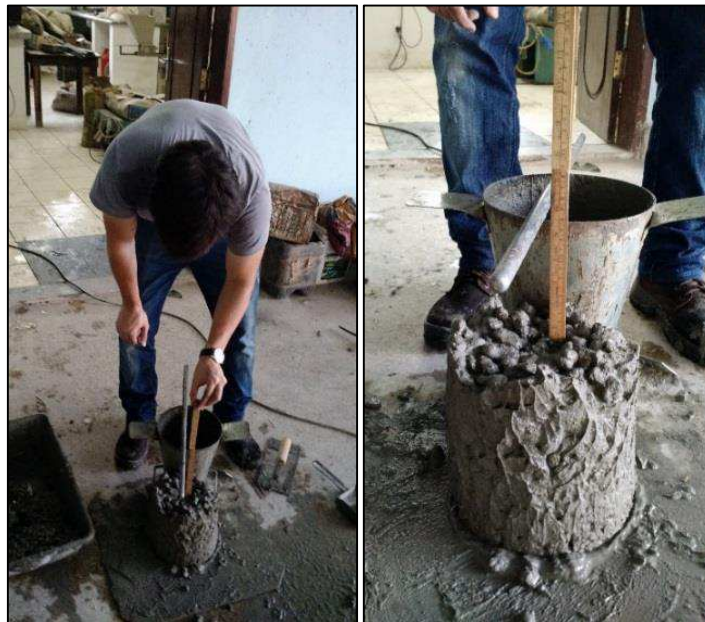
Figura 18 - Ensaio de Tronco de Cone.
