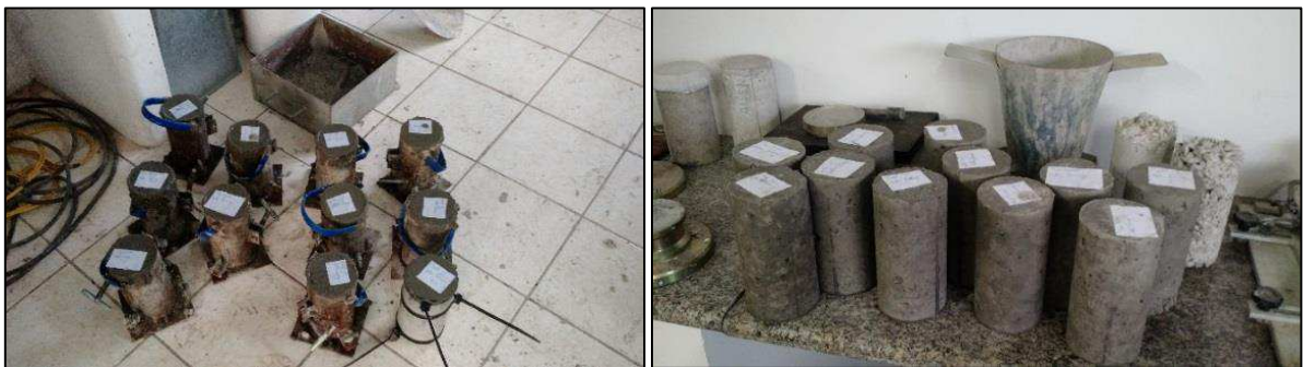
Figura 16 - Corpos de prova moldados.
