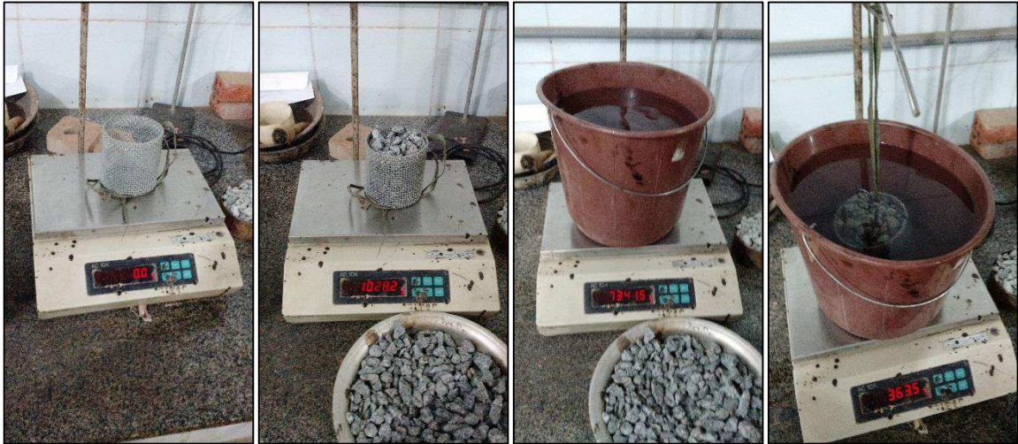
Figura 10 - Sequência do ensaio de massa específica do agregado graúdo.
