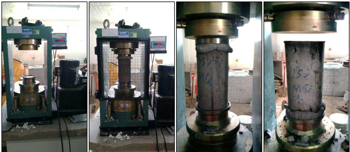
Figura 20 - Sequência do ensaio de compressão.
