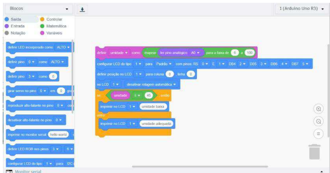
Figura 9: Codeblocks do sensor de umidade do solo
