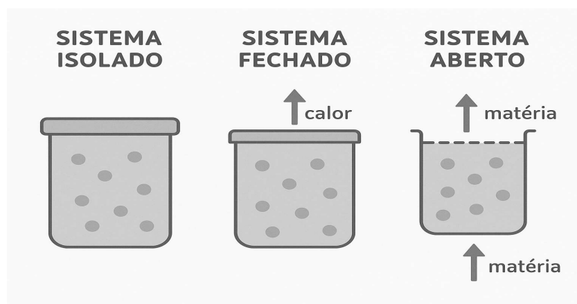
Figura 6 - Sistemas termodinâmicos: isolado, fechado e aberto.
