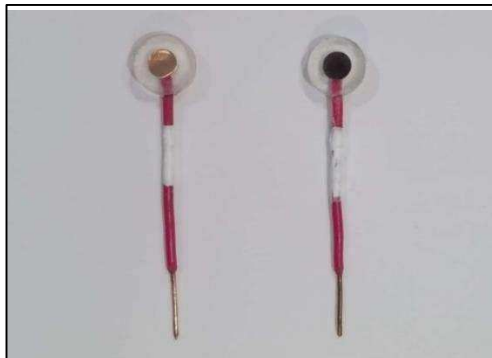
Figura 7- Representação do eletrodo de cobre não revestido e eletrodo de cobre revestido com Ni.
