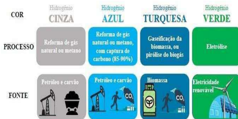
Figura 2- Esquema de classificação de cores e processos de obtenção do hidrogênio combustível.
