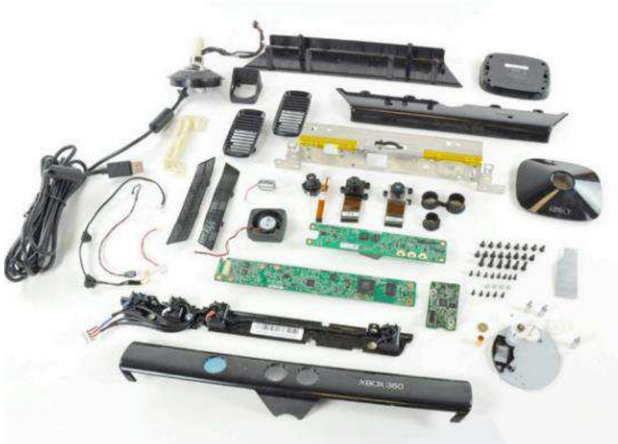
Figura 13: Elementos do Kinect [23]
