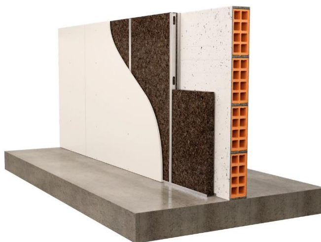
Figura 11: Composição de parede com alvenaria, painel de fibra de coco e drywall.
