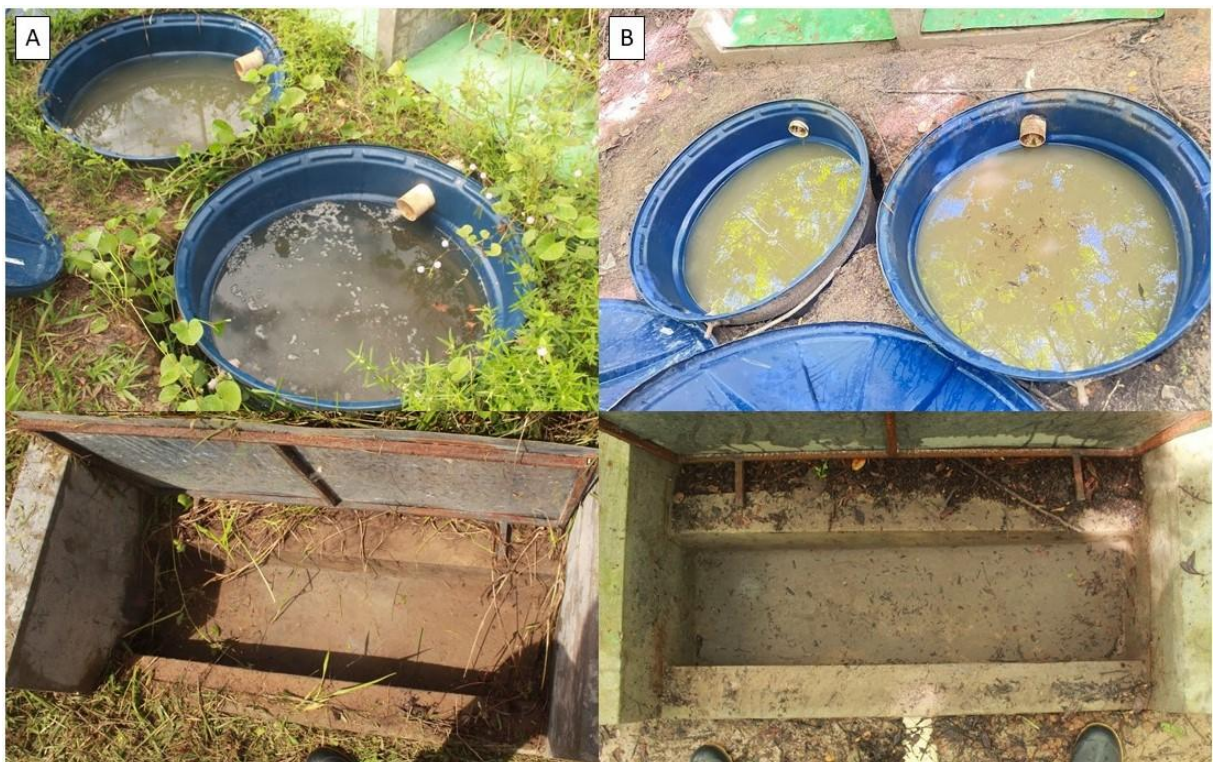
Figura 12: Presença de sedimentos nas calhas e nos reservatórios (A – calha e reservatórios da estação experimental com gramíneas; B – calha e reservatórios da estação experimental com vegetação de porte arbóreo).
