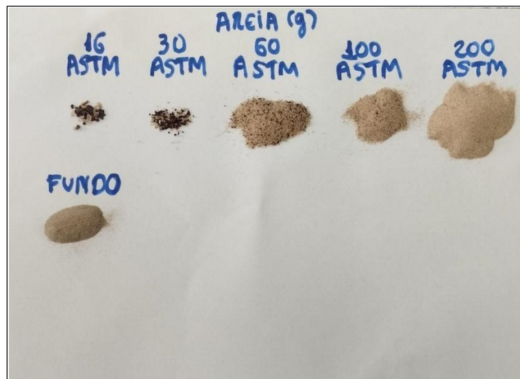
Figura 14 - Exemplo das areias separadas de acordo com a granulometria específica de cada malha.
