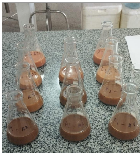
Figura 12 - Frascos de Erlenmeyer contendo amostras de solo e solução de hidróxido de sódio.
