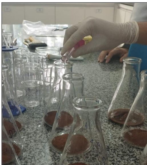
Figura 11 - Procedimento de ataque das amostras.
