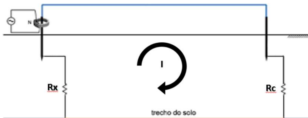
Figura 14 - Medição da resistência em laço fechado com alicate terrômetro
