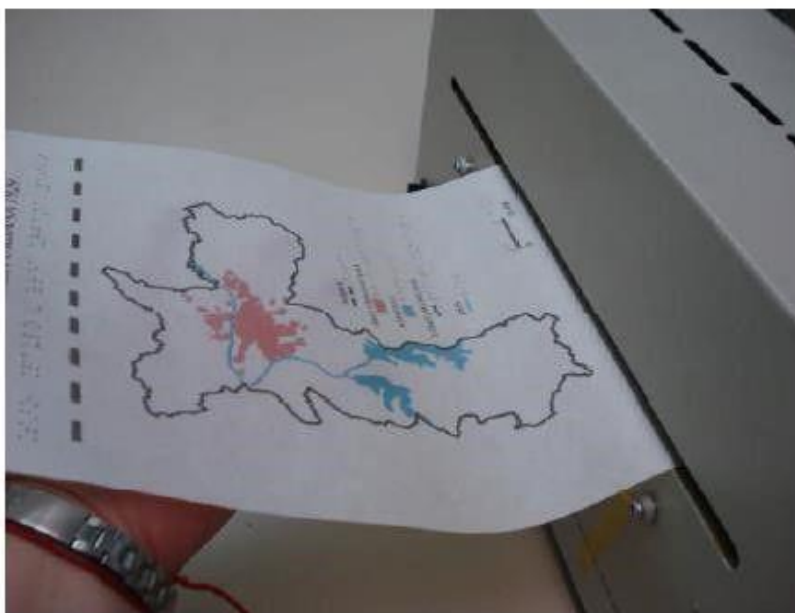
FIGURA 14: Mapa em papel micro capsulado sendo aquecido máquina especial (Tactile Imagem Enhacer)
