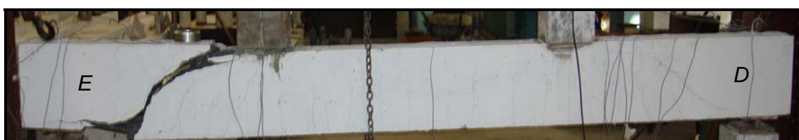
Foto 4.13 – Viga V80- 2 fissurada
