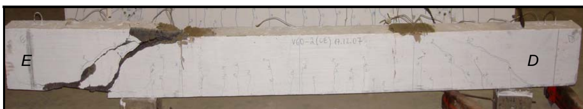
Foto 4.12 – Viga V60- 2 fissurada
