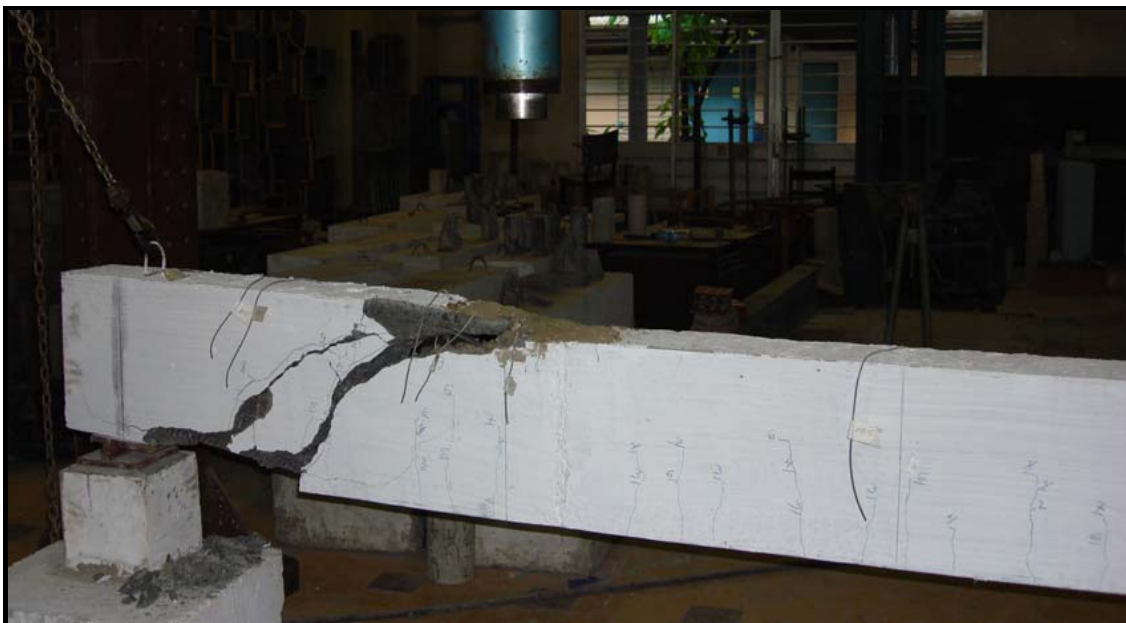
(b) Fissura dupla de cisalhamento – V60-2
