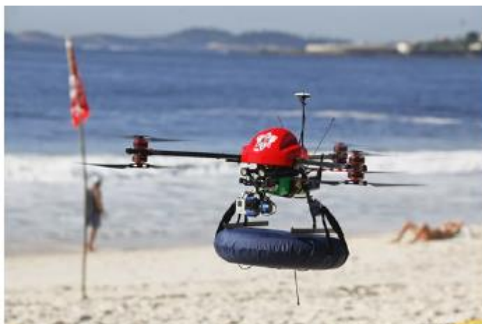
Figura 9 - Aeronave Remotamente pilotada com boia acoplada, utilizada pelo CBMERJ, em Copacabana, durante Operação Verão 2016.
