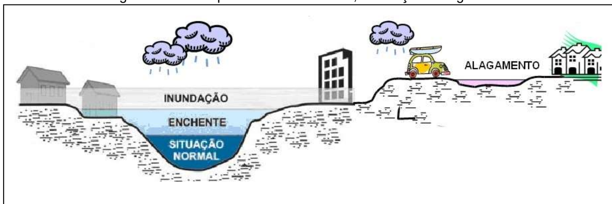
Figura 2-Perfil Esquemático de enchente, inundação e alagamento
