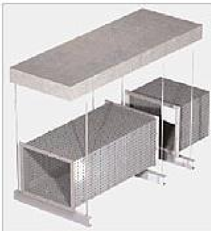
Figura 7 – Duto para extração de fumaça.
