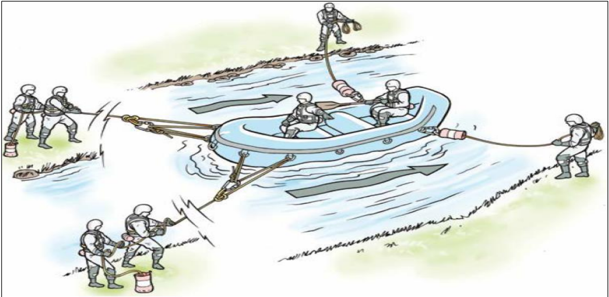
Figura 18 – Técnica em “V” em 4 pontos.
