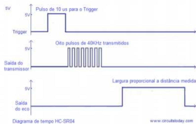
Figura 16 – Diagrama de funcionamento do sensor HC-SR04
