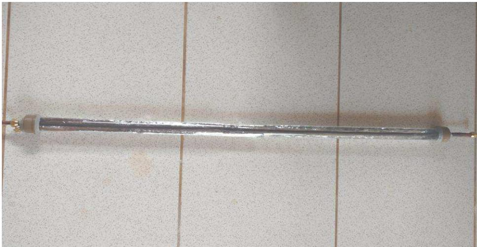
Figura 7: Coletor fabricado com lâmpada fluorescente.
