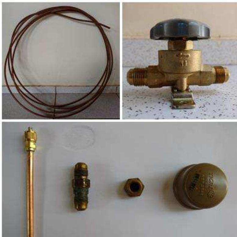
Figura 8: Materiais e dispositivos para montagem do coletor.
