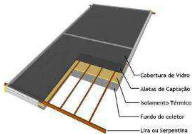
**Figura 4: Composição de um coletor solar plano.**
