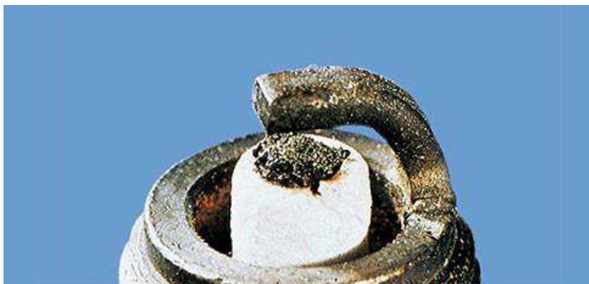
Figura 6: Eletrodo central fundido
