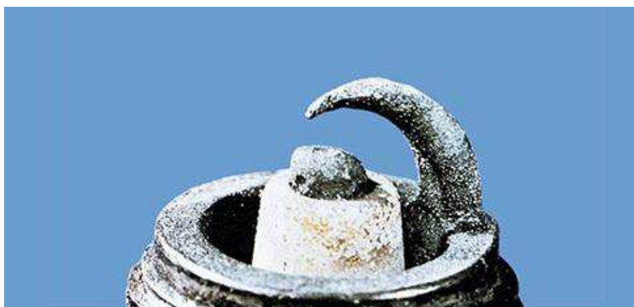
Figura 8: Desgaste no eletrodo-massa e central
