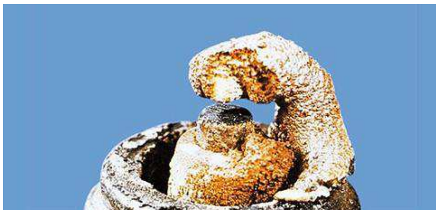
Figura 7: Eletrodo-massa e central com camada de escórias
