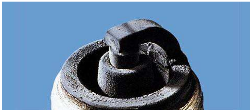
Figura 5: Fuligem preta no eletrodo de massa, central e no isolador
