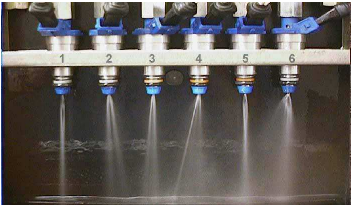
Figura 11: Teste dos bicos injetores
