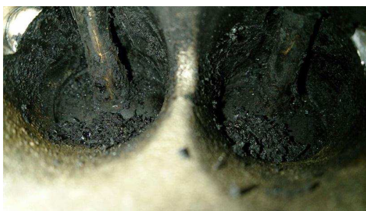
Figura 2: Carbonização nas válvulas
