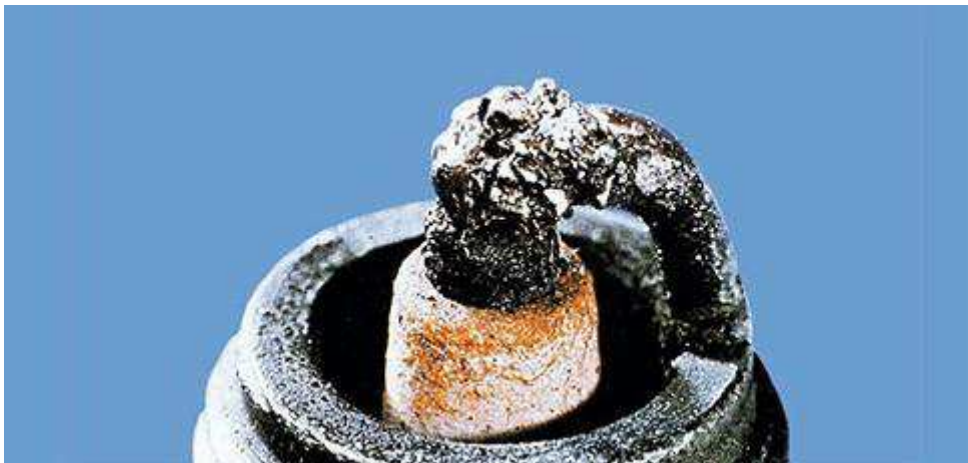
Figura 9: Eletrodo-massa e central fundidos
