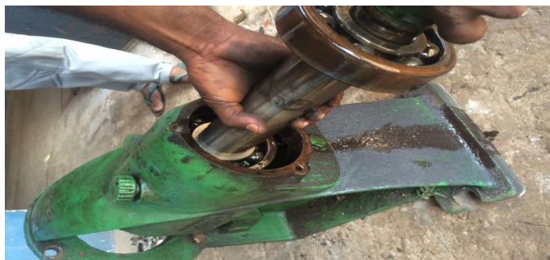
Figura 56. Instalação dos Rolamentos
