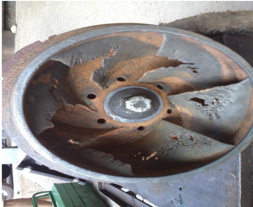
Figura 26. Cavitação no Rotor, Sistema Rio da Prata-Caema.
