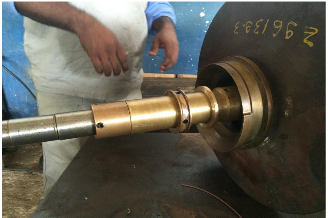
Figura 37. Colocação do Anel de Lanterna
