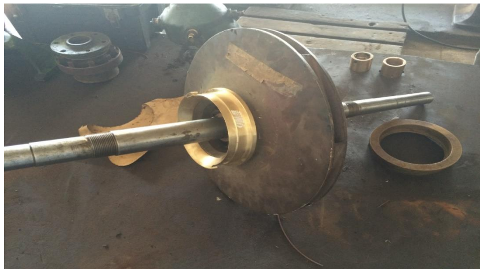
Figura 34. Colocação dos Anéis de Desgastes
