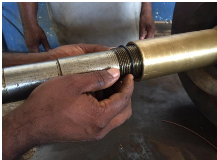
Figura 36. Colocação do Anel de O'ring.
