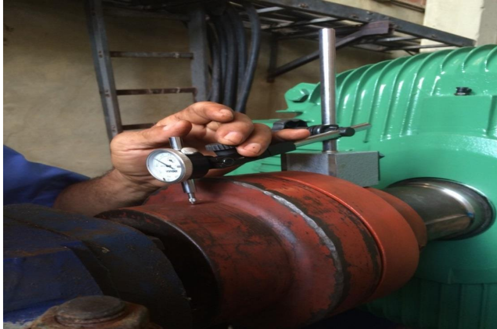
Figura 51. Alinhamento com relógio comparador
