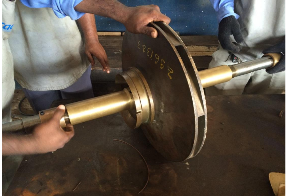
Figura 35. Colocação da Bucha no Eixo.
