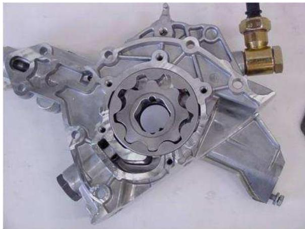
Figura 2.5 – Bomba de óleo de Rotor
