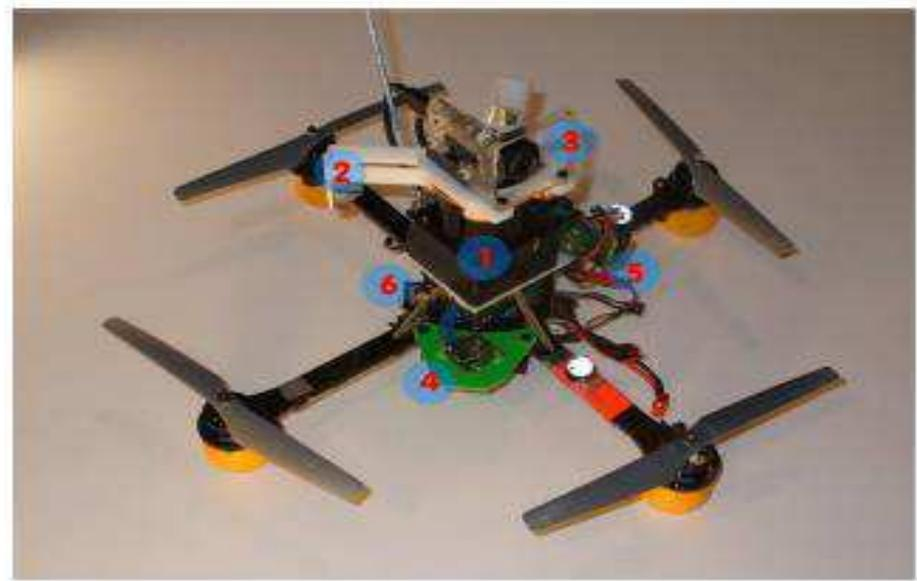
Figura 3-VANT (Quadricóptero) utilizado para realizar mapeamentos de ambiente
