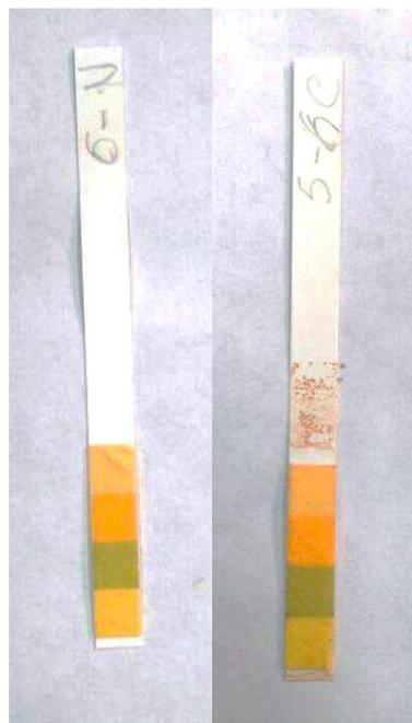
Figura 39 – Nível de pH - (esquerda) Meio sem metal; (direita) Meio com metal
