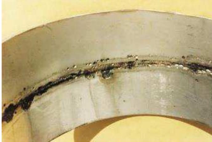
Figura 13 – Corrosão em torno do Cordão de Solda
