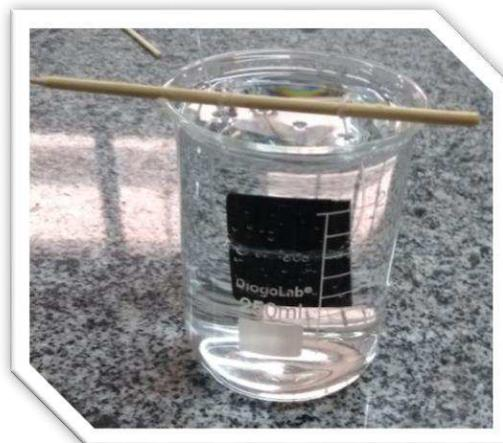
Figura 31 – Corpo de prova submerso com solução aquosa com 3% de NaCl
