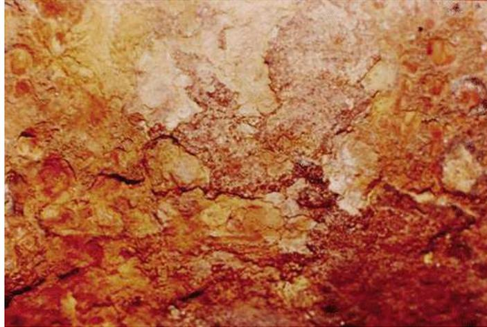
Figura 8 – Corrosão Uniforme
