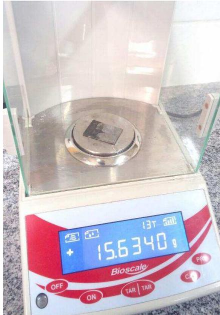
Figura 43 – Peso final da chapa após a realização do ensaio
