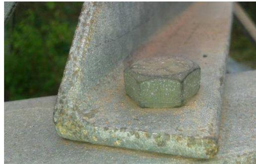
Figura 35 – Frestas 1 - contato superfície com superfície
