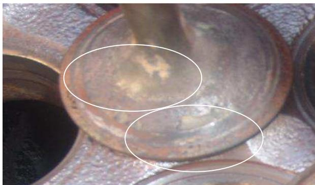
**Figura 19** - Erosão nas válvulas
