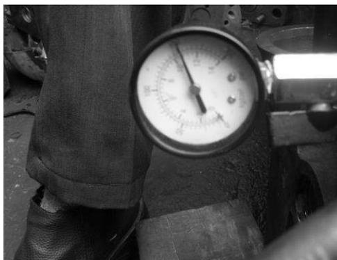
**Figura 53** – Manômetro detalhado em pressão de 10 bar
