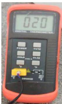
**Figura 42** - Termômetro portátil digital
