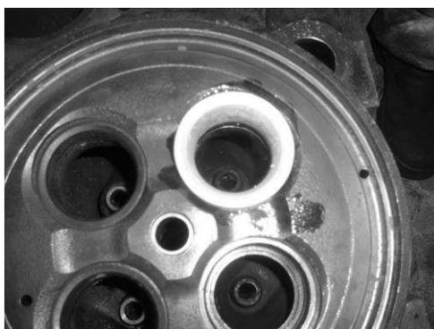
**Figura 52** – Uso de nitrogênio líquido para encaixe da sede
