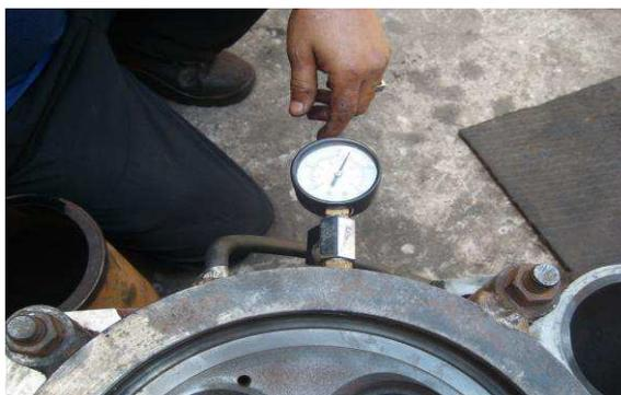
**Figura 25** - Equipamento de teste de estanqueidade
