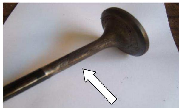
**Figura 28** - Erosão da haste da válvula de escape
