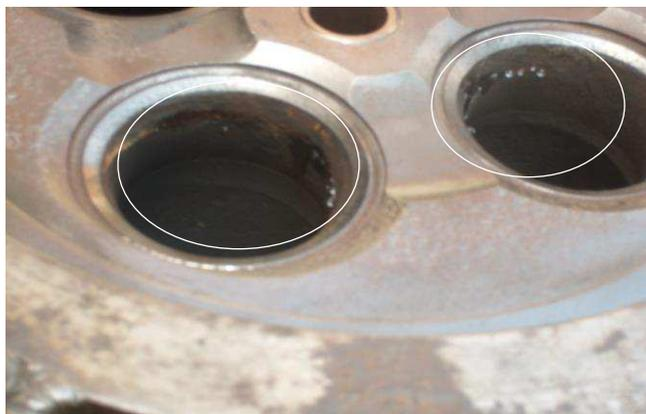
**Figura 26** - Vazamento nas sedes de válvula durante teste de estanqueidade
