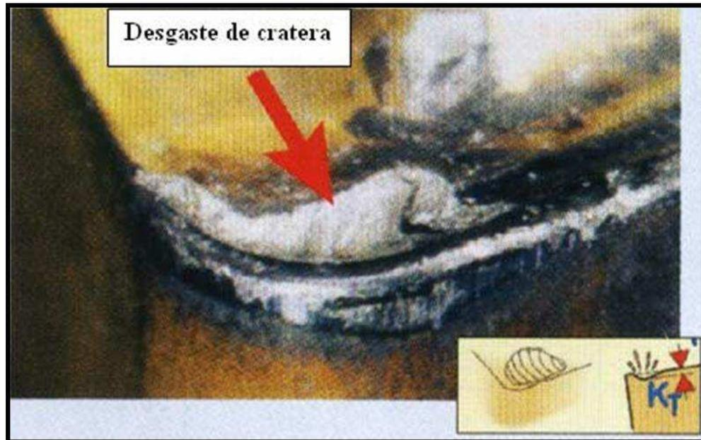
**Figura 2.22 - Desgaste de cratera na superfície de saída do cavaco (SANDVIK, 2005).**
