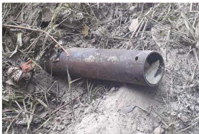
Corpo do motor logo após a explosão
