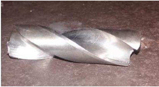
Figura 4.21 – Broca 3 quebrada durante a furação final Fonte: Autor (2018).
