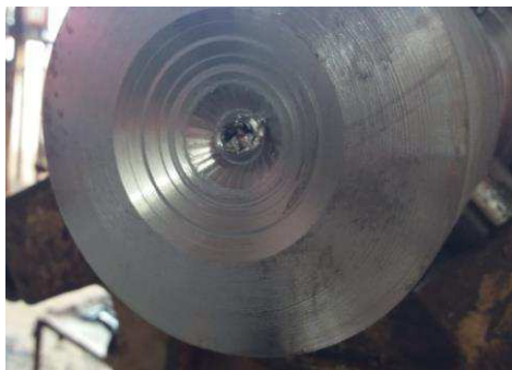
Figura 4.19 – Broca 1 quebrada no interior da seção convergente Fonte: Autor (2018).
