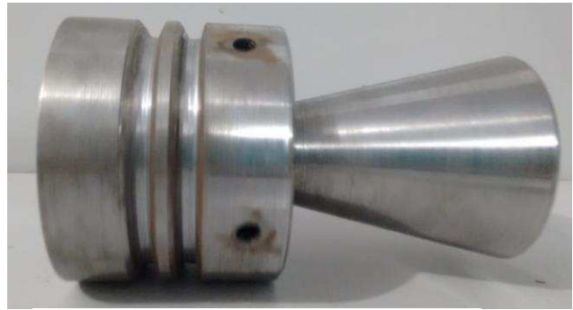
Figura 4.11 – Tubeira finalizada Fonte: Autor (2018).
