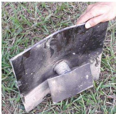
Figura 5.15 – Deformação sofrida pela mola Fonte: Autor (2018).
