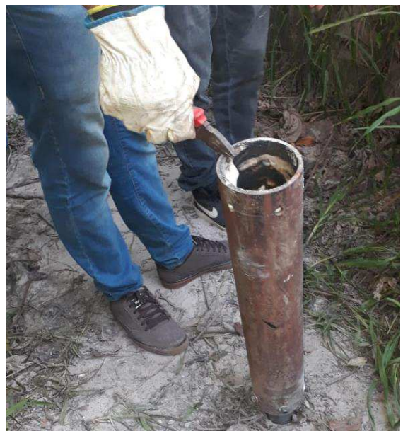
Corpo do motor após a explosão
