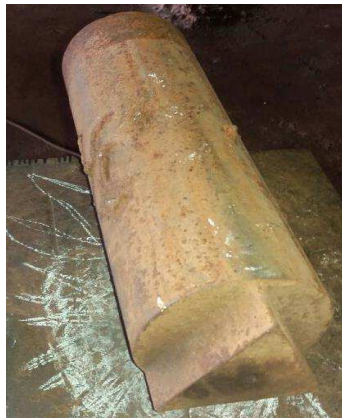
Figura 4.2 – Tarugo de aço utilizado Fonte: Autor (2018).
