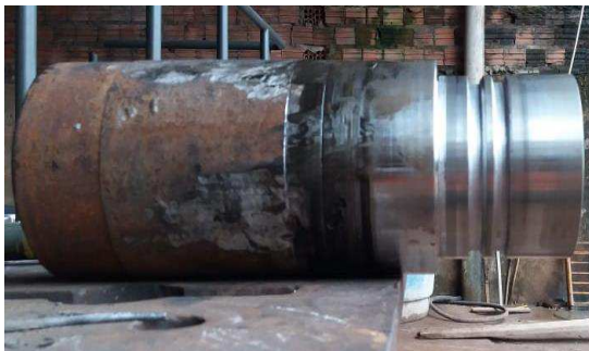
Figura 4.4 – Cabeçote pré-finalizado Fonte: Autor (2018).
