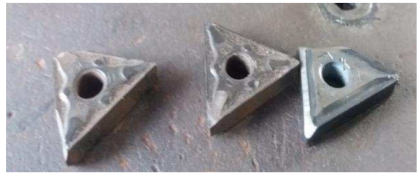
Figura 4.22 – As três ferramentas de corte quebradas durante a usinagem Fonte: Autor (2018).
