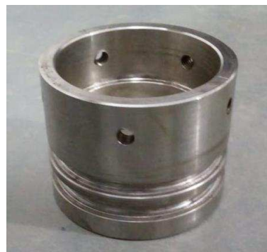
Figura 4.7 – Cabeçote finalizado Fonte: Autor (2018).
