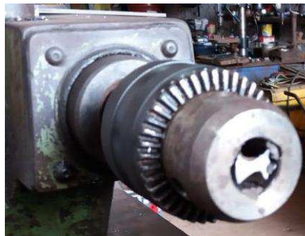
Figura 4.20 – Broca 2 quebrada no mandril de furção Fonte: Autor (2018).
