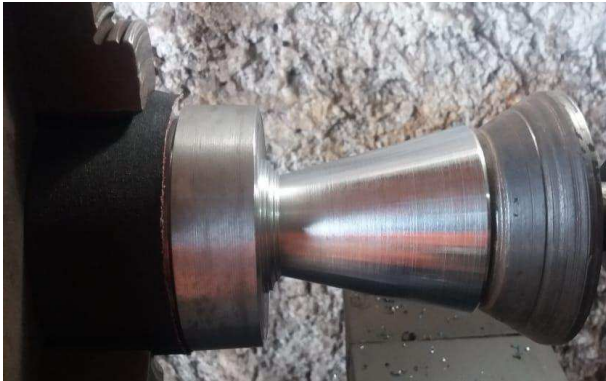
Usinagem da tubeira
