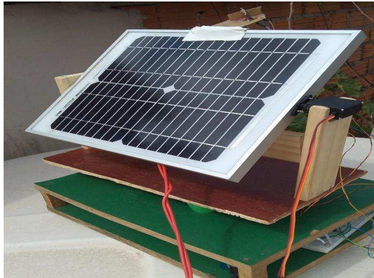
Figura 29: Seguidor solar com a placa fotovoltaica
