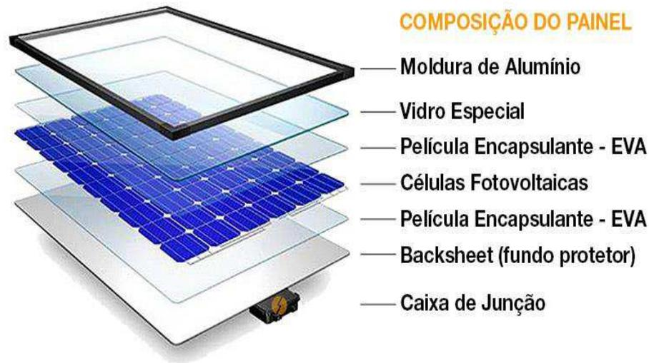
Figura 9: Materiais que compõem um painel fotovoltaico
