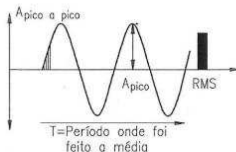
Figura 3.10 - Forma de onda senoidal (relação entre pico e RMS)
