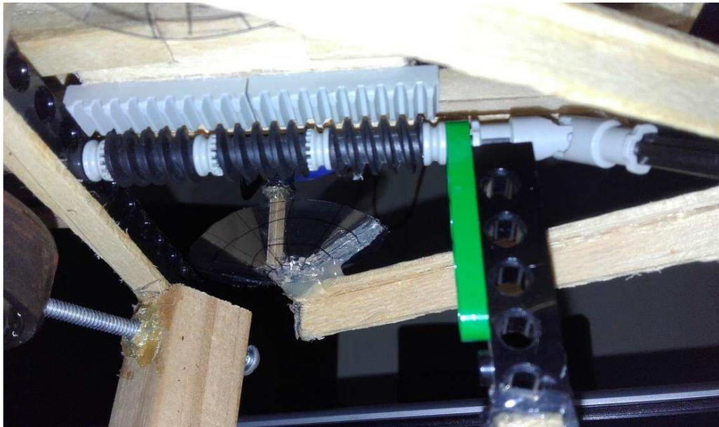
Figura 24: Montagem da sistema de translação horizontal
