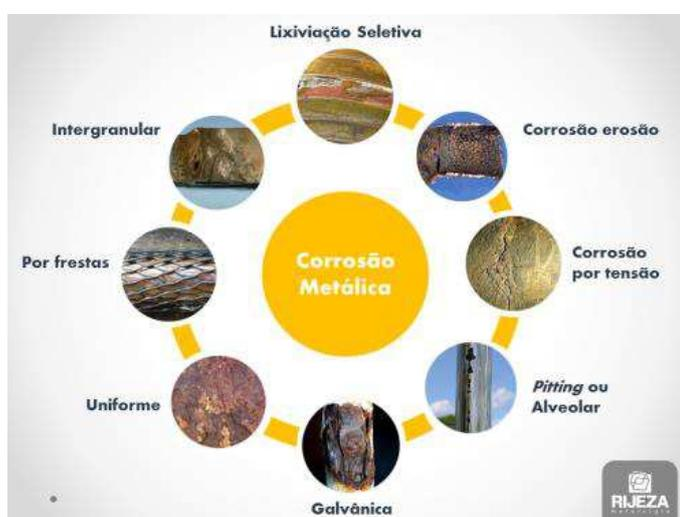
Figura 8: Tipo de corrosão metálica
