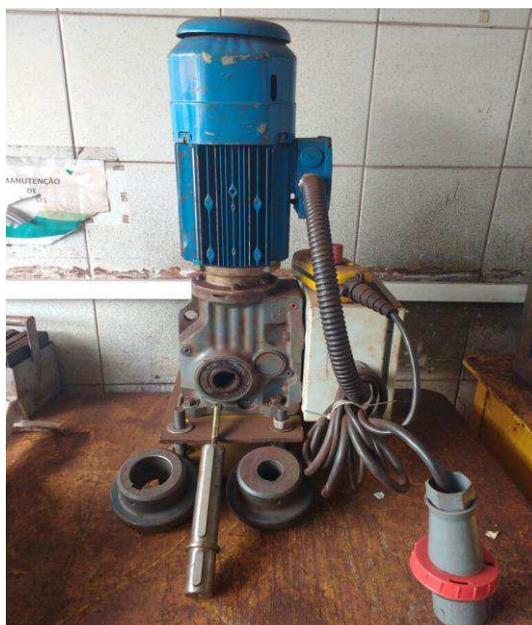
Figura 27 Acionamento auxiliar montado
