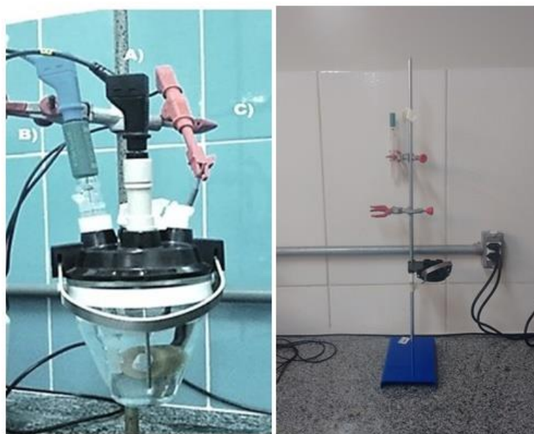
Figura 12 - Eletrodos utilizados: (a) Eletrodo de Platina; (b) Eletrodo de Referência de Calomelano Saturado; (c) Eletrodo de Trabalho e o suporte.
