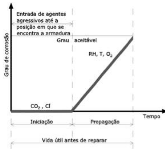
Figura 6: Modelo de Tuutti para a corrosão de armaduras.
