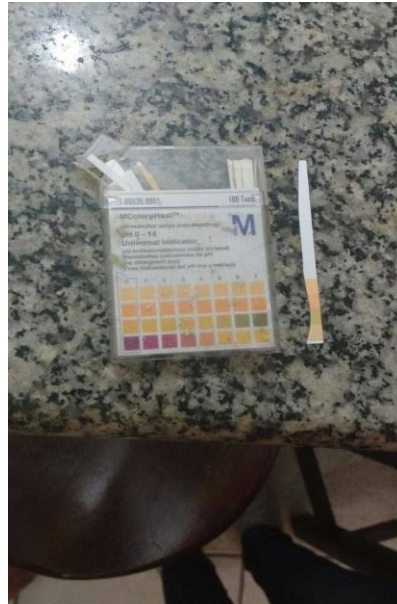
Figura 17- Equipamento utilizado no ensaio do potencial Hidrogeniônico
