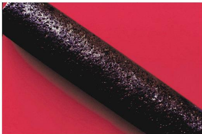
Figura 6- Pites em tubo de aço carbono (GENTIL, V 2007)
