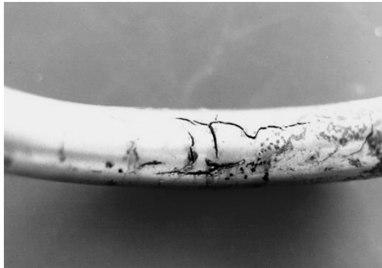
Figura 7- Barra de aço com corrosão sob tensão fraturante, Fonte: GENTIL, V 2003.
