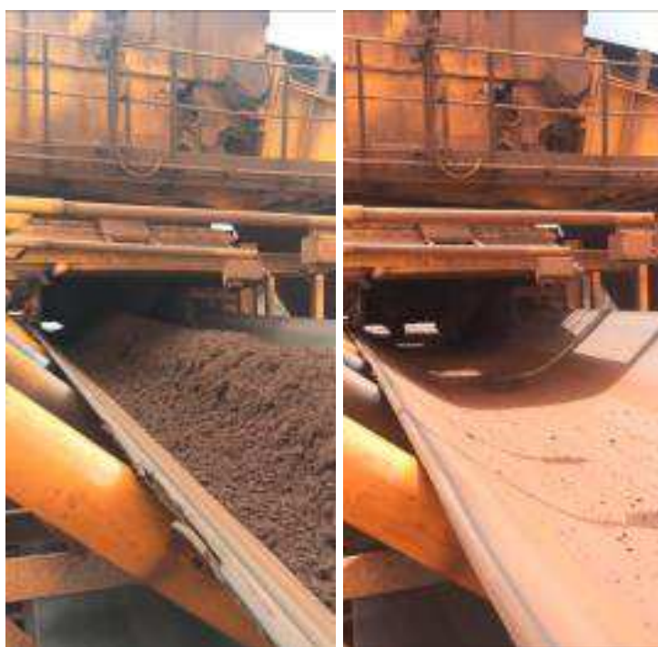
Figura 13 – Desalinhamento com carga (esquerda) e sem carga (direita)
