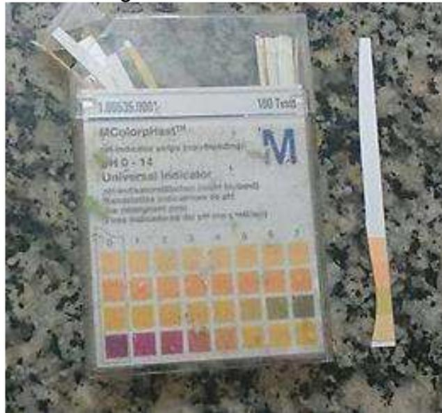
Em cada amostra (mar e lago) foi introduzida uma fita (Figura 23), após alguns segundos, através da mudança de coloração, foi possível a detecção do valor do pH por meio da comparação da cor resultante com a tabela de cores apresentada na caixa das fitas.
