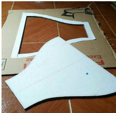
Com todas as peças cortadas, realizou a montagem utilizando álcool para moldagem do papelão e cola instantânea para fixação, iniciando-se pela seção de testes, assim como ocorreu no dimensionamento.
