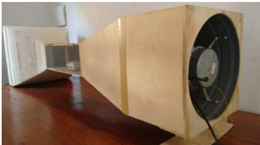
Com a análise das melhorias a serem feitas para o protótipo final, realizou-se a construção mini túnel de vento.
