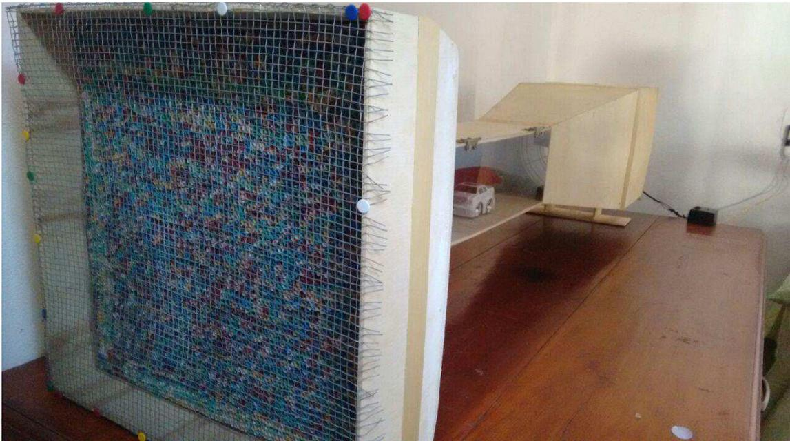
Com o túnel de vento pronto, novamente aferiu-se a velocidade na seção de testes e foi encontrado o valor de 10 m/s, anulando o erro encontrado no protótipo em relação aos parâmetros de projeto.
