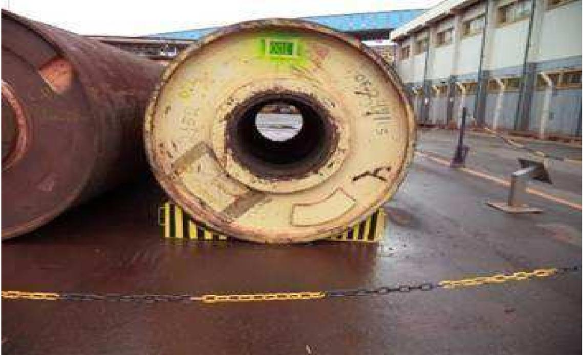
Na Figura 13 acima, foram colocados calços adequados para suportar o peso caso viesse a rolar para o lado. Além disso, foi feita uma lavagem do local para garantir a retirada de impurezas ou objetos que não deveriam estar no espaço destinado para tal fim, garantindo assim, o objetivo do senso da limpeza. Logo em seguida nas Figuras 14 e 15, a continuidade da aplicação do senso da ordenação, saúde e limpeza.
