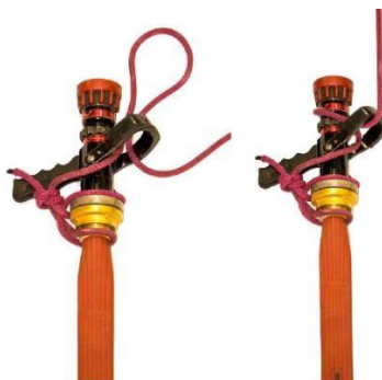
Figura 50 - Içamento de Mangueiras
