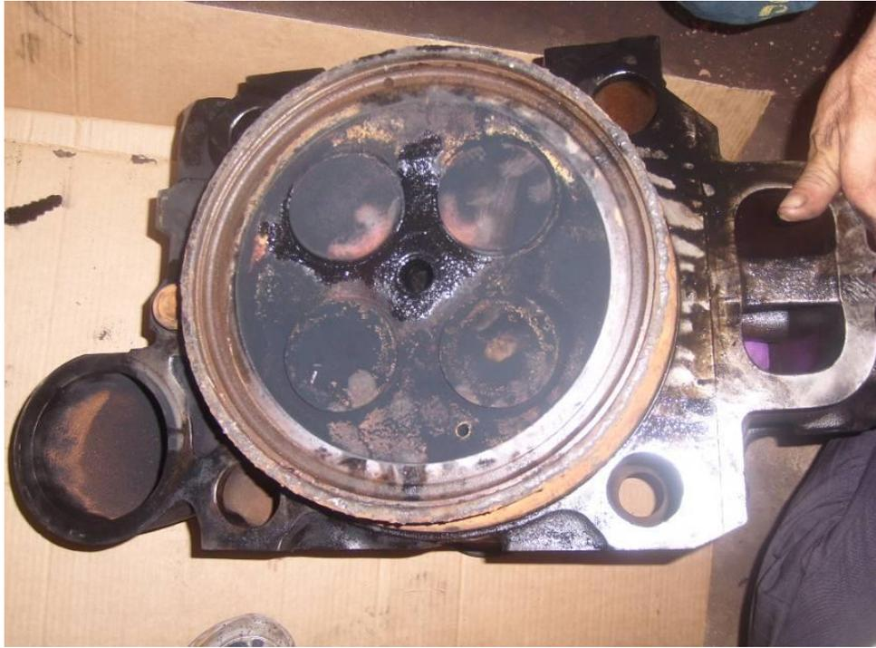
Figura 05- Cabeçote de um motor 08M Caterpillar antes da desmontagem.
