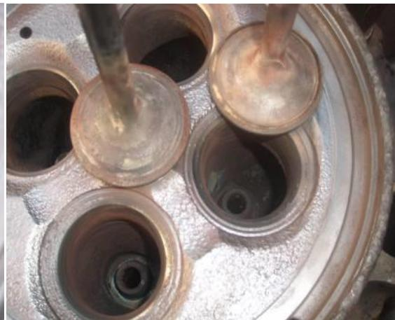
Figura 07 – Válvulas e guias de válvulas com desgaste acentuado.
