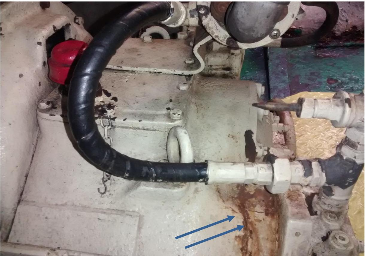
Figura 21 – Foto panorâmica da carcaça no reversor de rotação mostrando corrosão.
