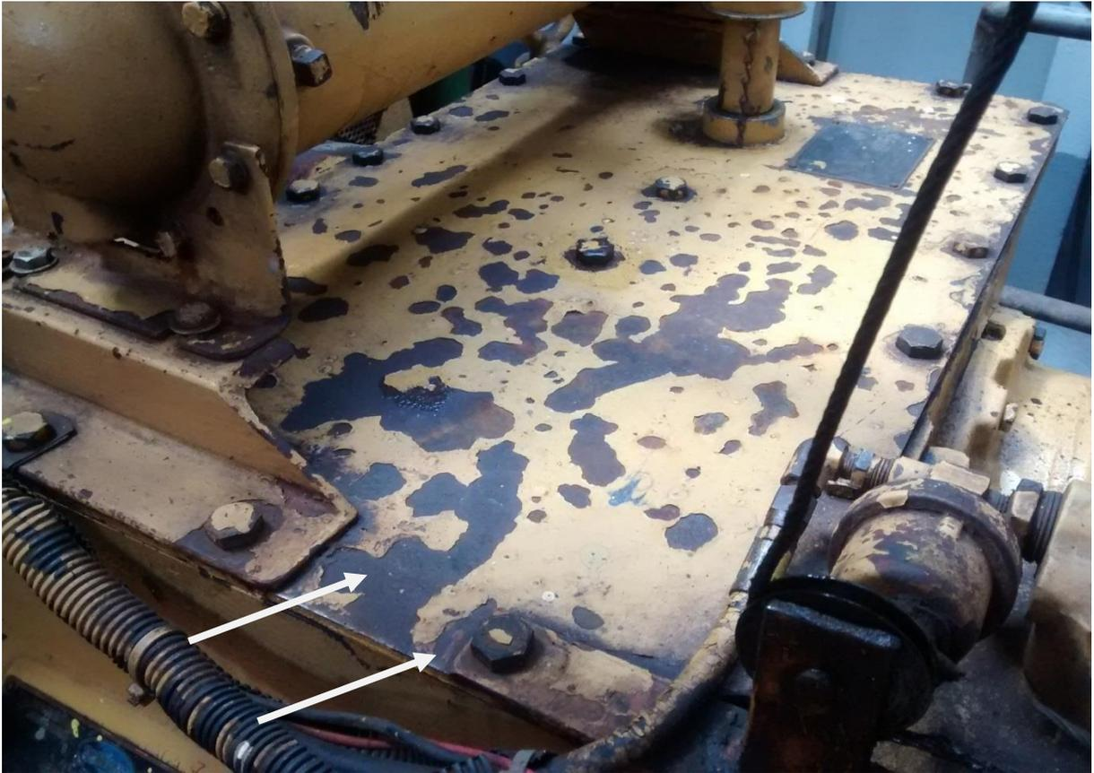
Figura 16 – Foto panorâmica da carcaça do motor mostrando corrosão.
