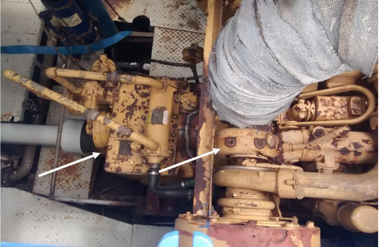
Figura 20 – Foto superior mostrando corrosão nos elementos de fixação.
