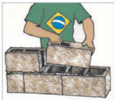
Figura 51: Argamassa colocada nas paredes e no topo do bloco
