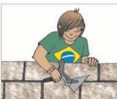
Figura 53: Raspagem do excesso de argamassa
