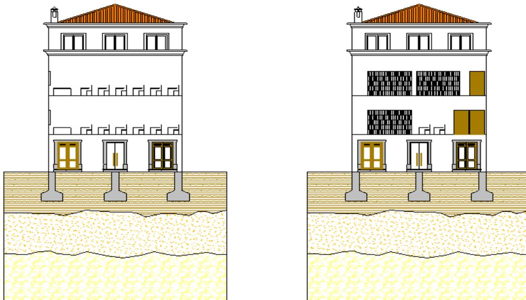
**Figura 38** – Exemplo de alteração do uso de uma estrutura, onde o projecto inicial era uma escola mas foram feitas modificações para o prédio ser usado como uma biblioteca (Modificado, Schnaid et al., 2005).
