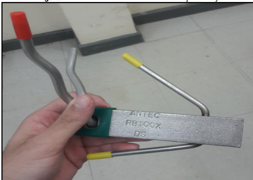
Figura 11 - Âncora metálica fabricada em aço incoloy
