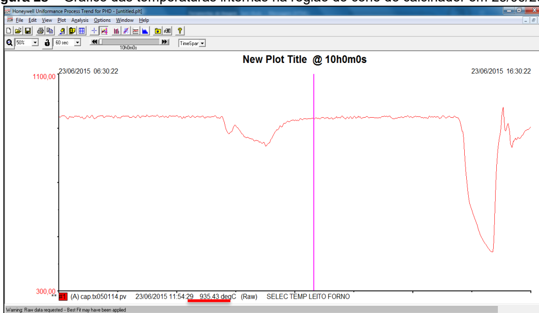
Figura 18 – Gráfico das temperaturas internas na região do cone do calcinador em 23/06/2015
