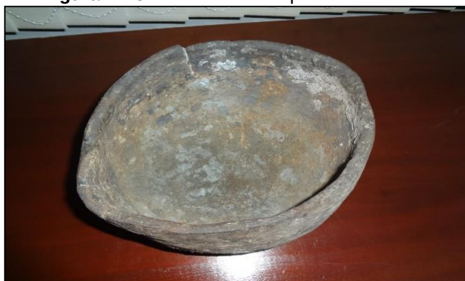
Figura 1 - Cadinho refratário para fundir metal
