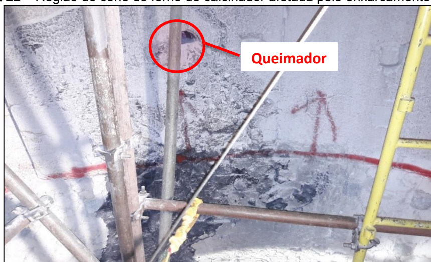
Figura 22 – Região do cone do forno de calcinador afetada pelo enxarcamento de óleo
