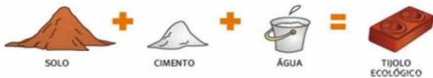
Figura 5 – Componentes do tijolo solo-cimento
