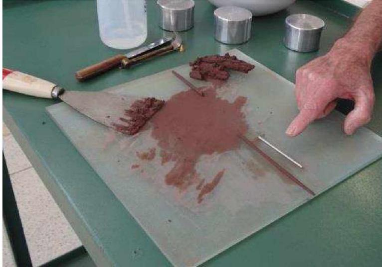
Figura 2 – Cilindro quebradiço de solo com aproximadamente 1,5mm de raio
