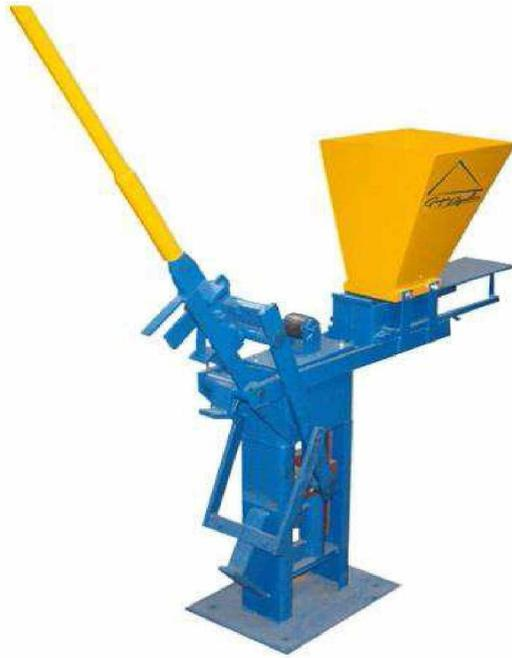
Figura 24 – Máquina manual de tijolos ecológicos solo-cemento modular
