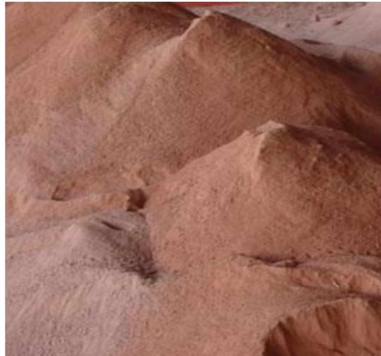
Figura 21 – Solo após trituração e peneiramento.
