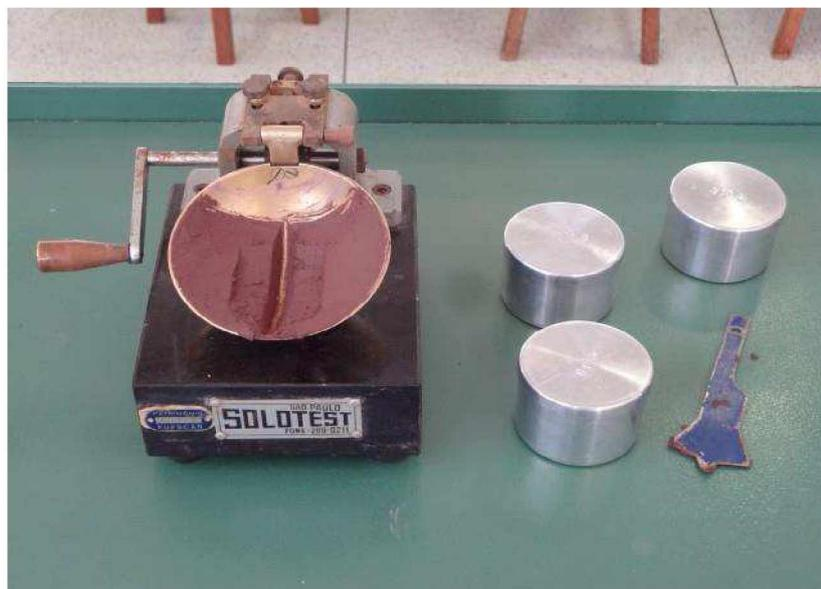
Figura 1 – Aparado de Casagrande e ranhura em amostra de solo.
