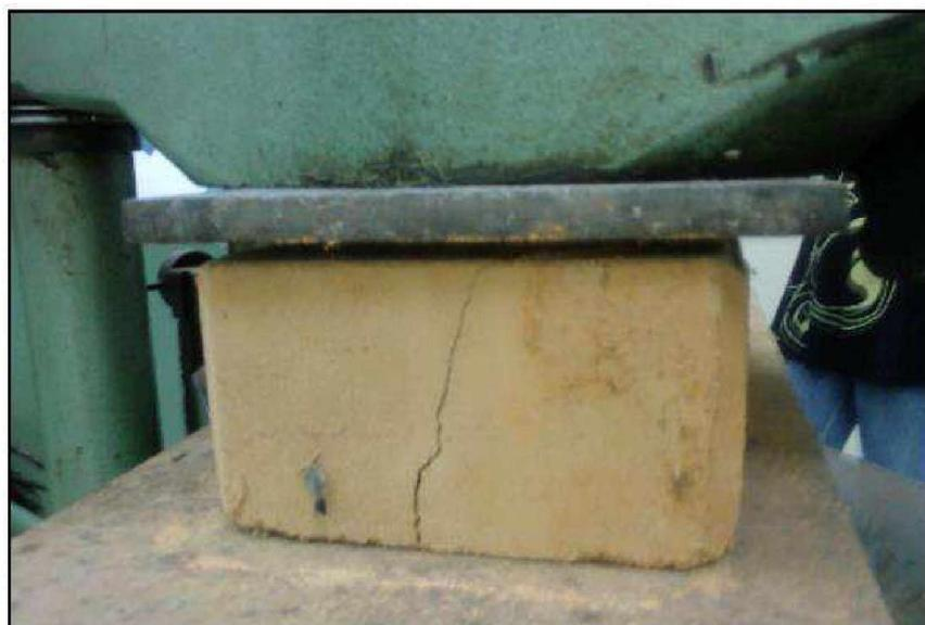
Figura 16 – Trinca em corpo de prova de solo-cimento sob o ensaio de compressão simples
