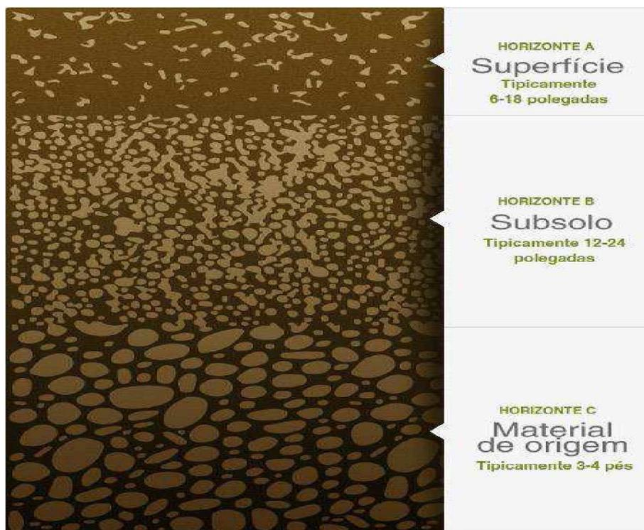
Figura 4 – Desenho esquemático representando os três perfis do solo
