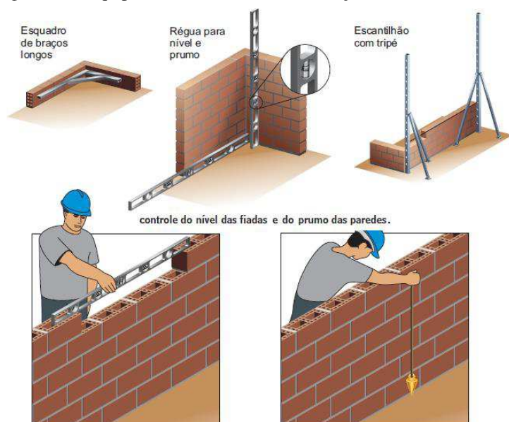
Figura 17 – Equipamentos auxiliares na execução e controle das alvenarias.
