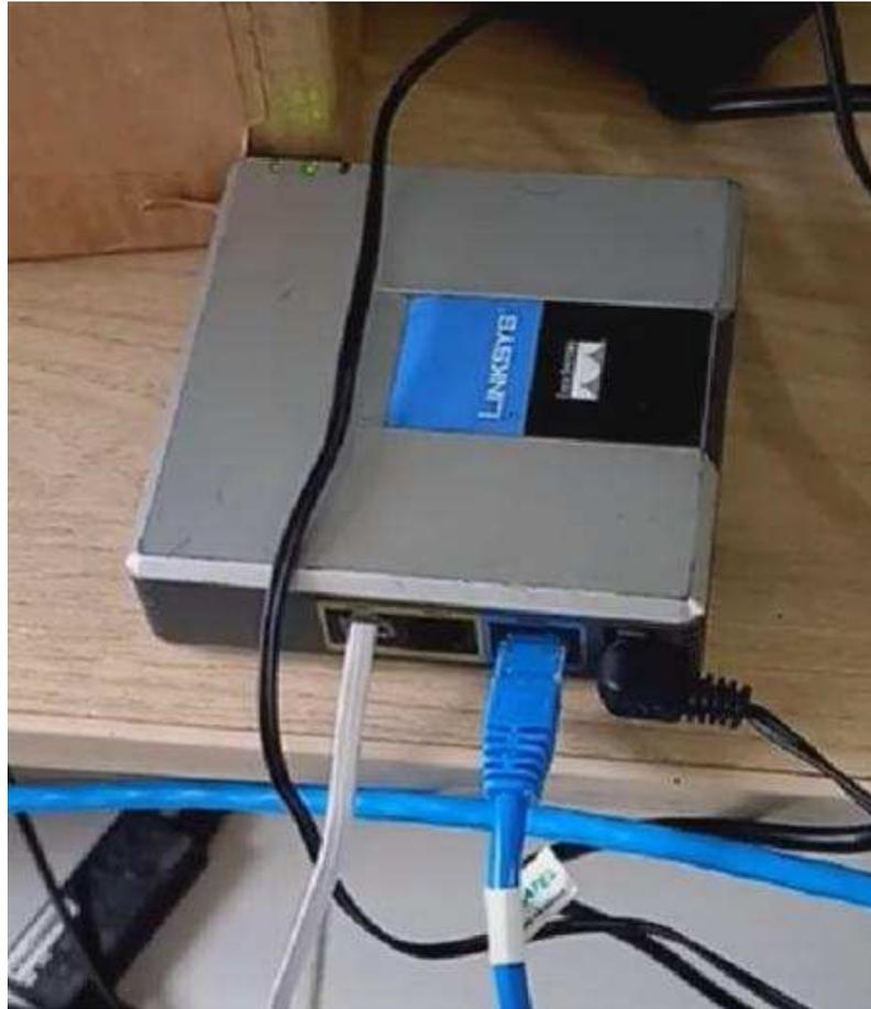
Figura 22: ATA PAP2T Linksys Adaptador VoIP. Fonte: Autor.
