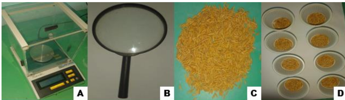
Figura 2- Materiais utilizados para a análise física: Balança analítica (A), Lupa (B), Amostra de sementes crioulas de arroz (C), Peso de Mil Sementes (D).
