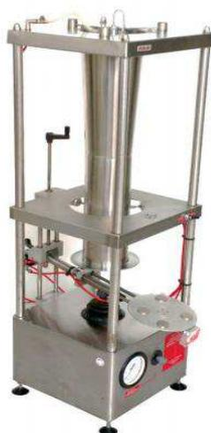
**Figura 4** – Torre de pulverização de Potter (Burkard, Rickmansworth, UK). Imagem: Rêgo (2018).
