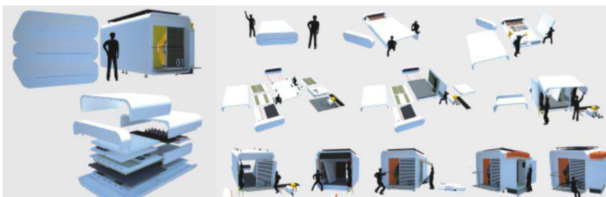
Figura 19: Esquema de montagem do abrigo emergencial efêmero de Giovana Feres.
