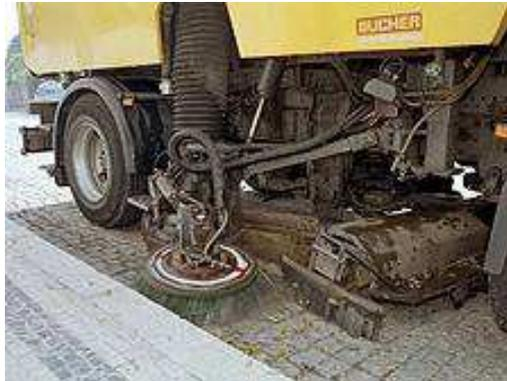
**Figura 19** – Equipamento de varrição Mecanizada
