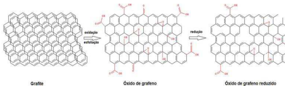
Figura 10 – Estrutura molecular da produção e redução do óxido de grafeno
