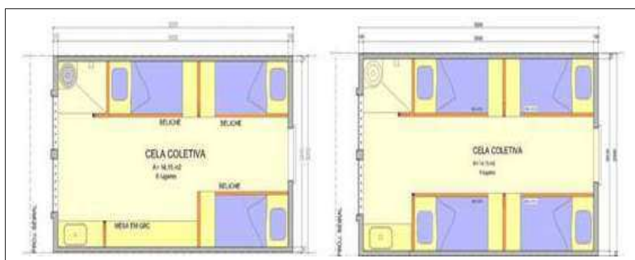
Figura 7 – Módulo de Cela Coletiva, seis e oito vagas MCC6P.
