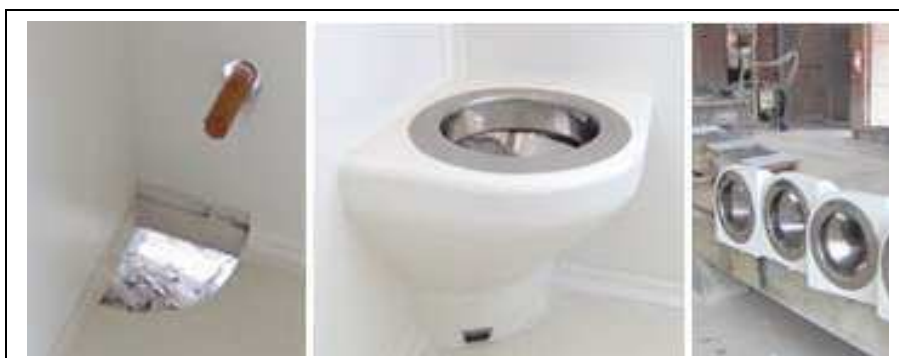
Figura 17 – Bacia sanitária (da esquerda para a direita): encaixe no piso da peça, detalhe e bacias produzidas na fábrica.
