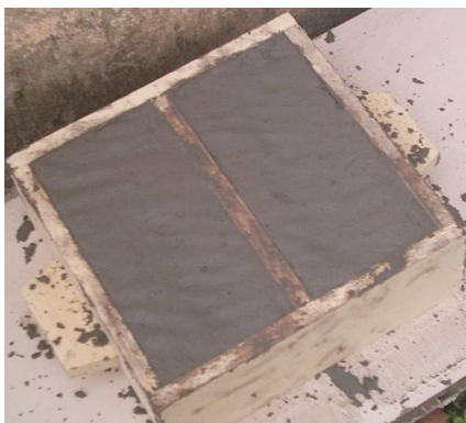
Fig. 51 Moldagem dos tijolos Fonte: Nogueira, 2006
