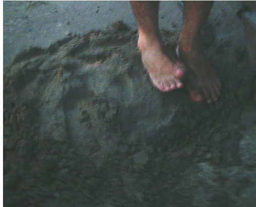
Fig. 50 Amassamento para produção de tijolos Fonte: Nogueira, 2006
